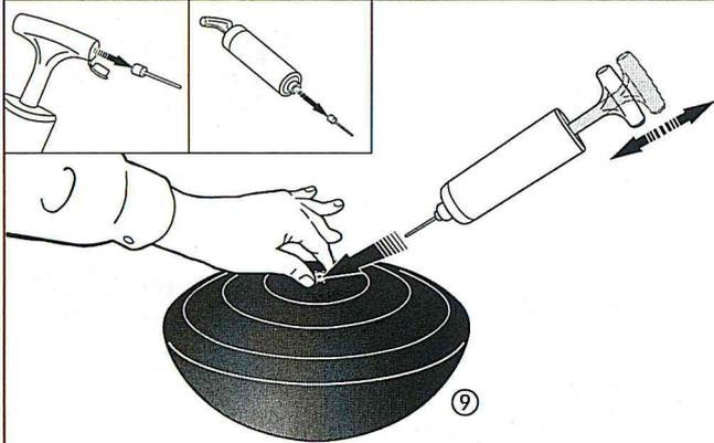
**D** VERRINGERN DER LUFTMENGE: Entnehmen Sie die Nadel seitlich aus dem Griff der Pumpe und stecken Sie die Nadel bis zum Anschlag in das Ventil. Drücken Sie anschließend mit beiden Händen auf das Luftkissen.
